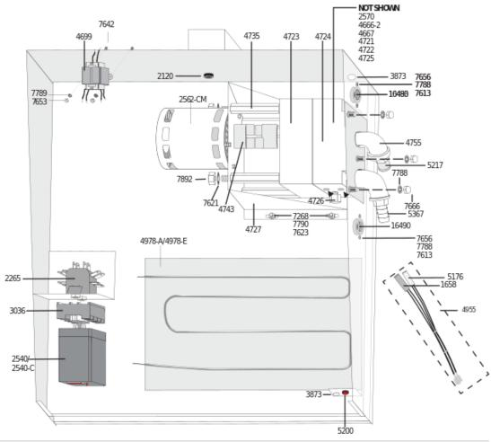
4750 - DUAL CDC PUMP COMPONENTS ASSEMBLED
